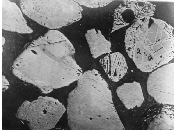
Şək.2. Titanomaqnetit qumdaşları (145 dəfə böyüdülmüş)
